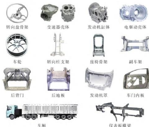
图 26：多家主机厂已经在多类汽车零部件环节采用镁合金替代原方案
